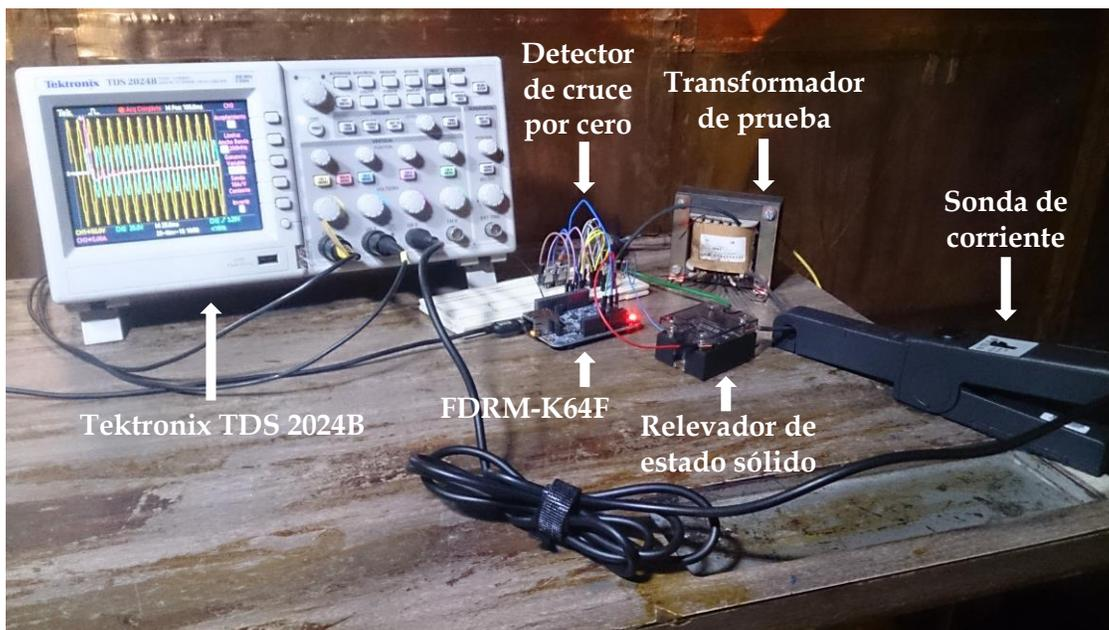
Fig. 3.5. Circuito experimental para control y medición de la corriente de energización.
