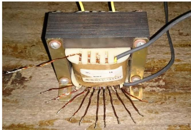
Fig. 3.2. Derivaciones disponibles de la tercera capa del devanado primario del transformador.
