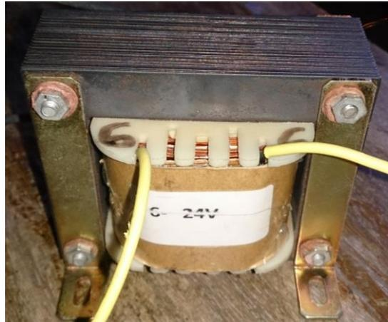
Fig. 3.1. Transformador de 120VA bajo prueba
